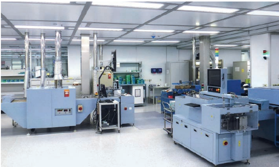
Abb. 2: Produktionsbereich der ISO-Reinraumklasse 7
